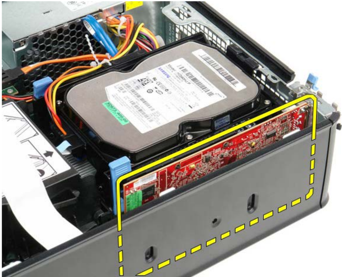
1 11 1 11 拿着插卡的顶部边角，轻轻地将其从连接器中取出。
