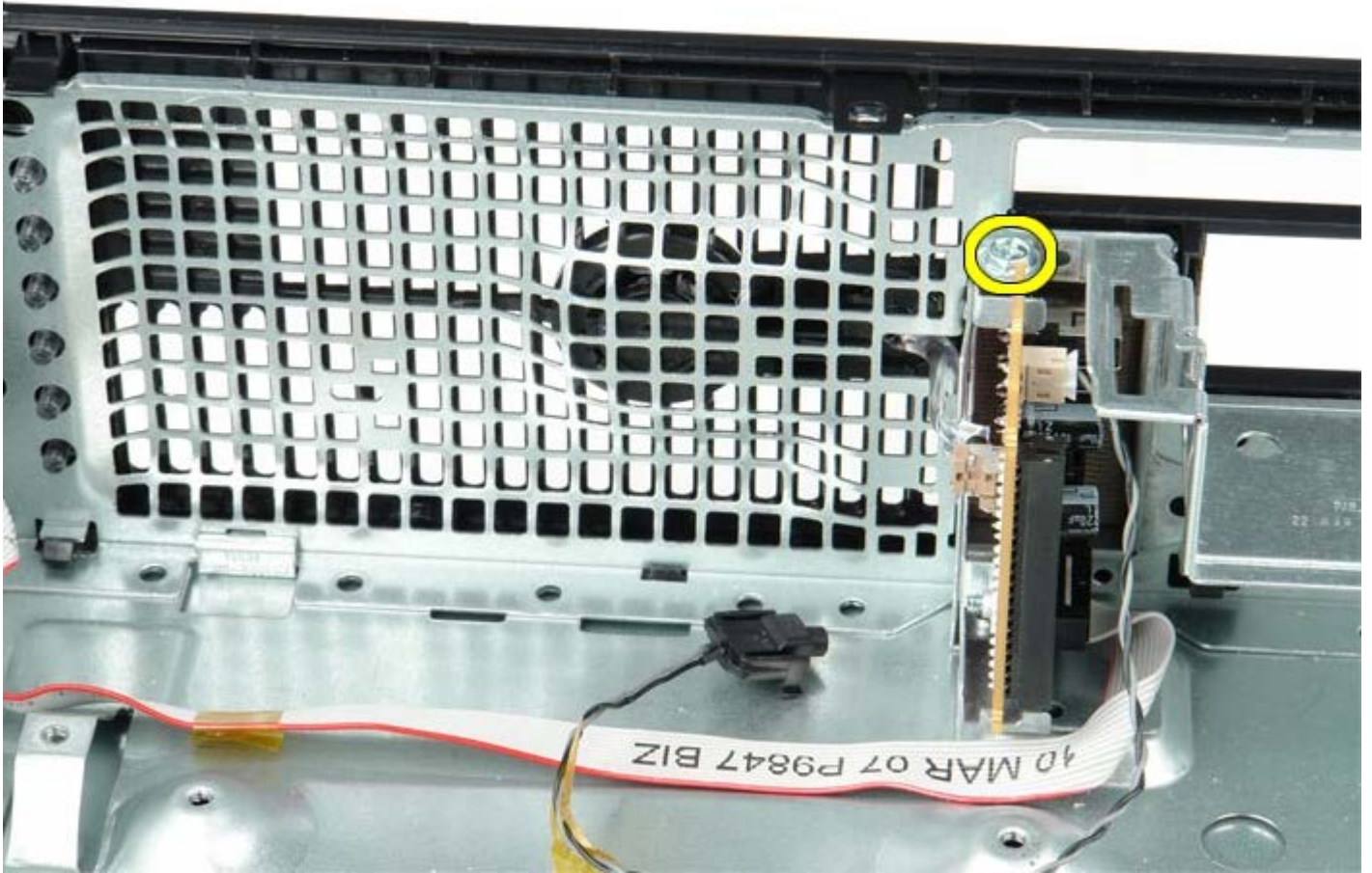
1 11 松动 IO 面板，将其圆形卡舌从机箱孔中释放出来。卸下 IO 面板。
