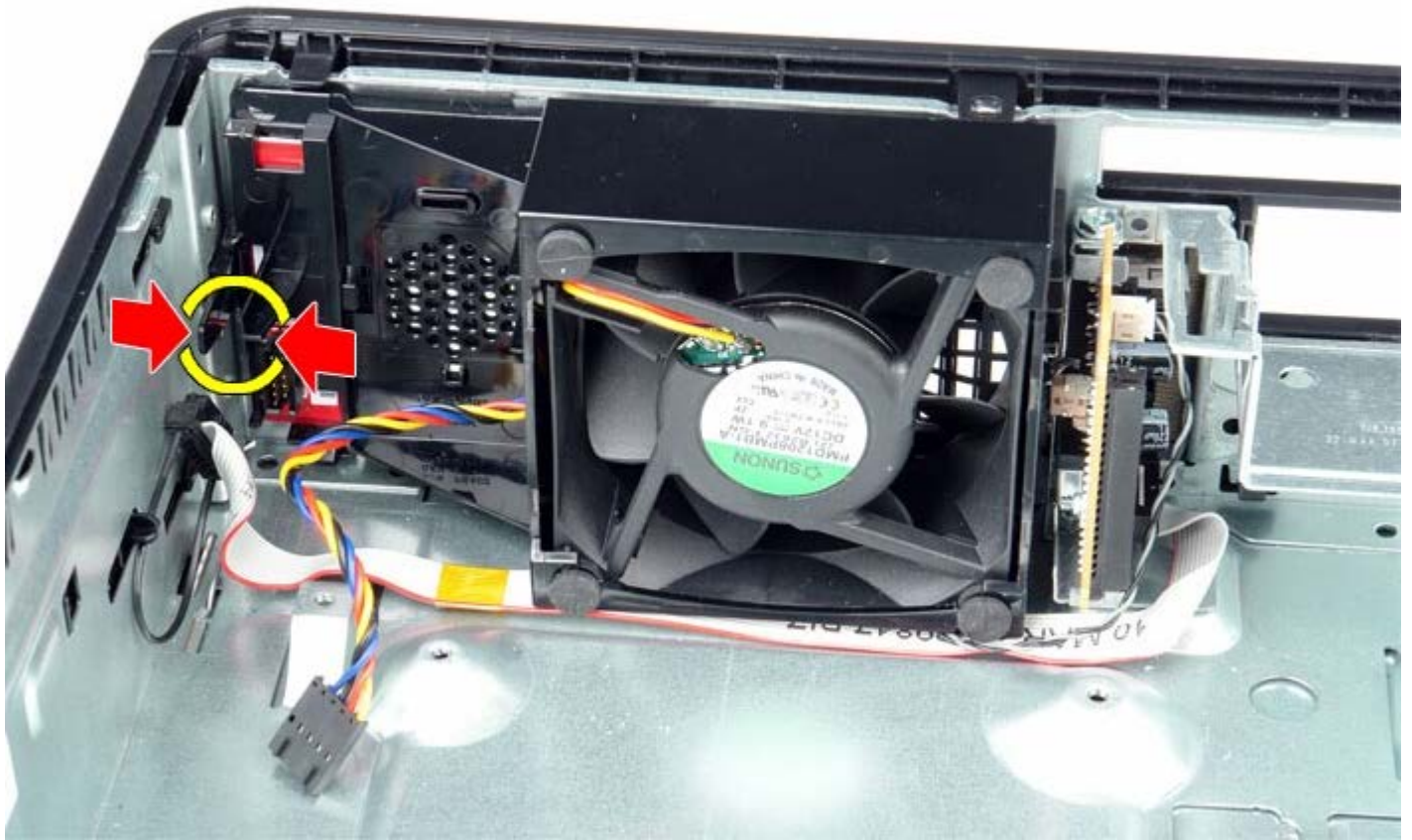
1 11 向前倾斜风扇，将其从计算机机箱中取出。
