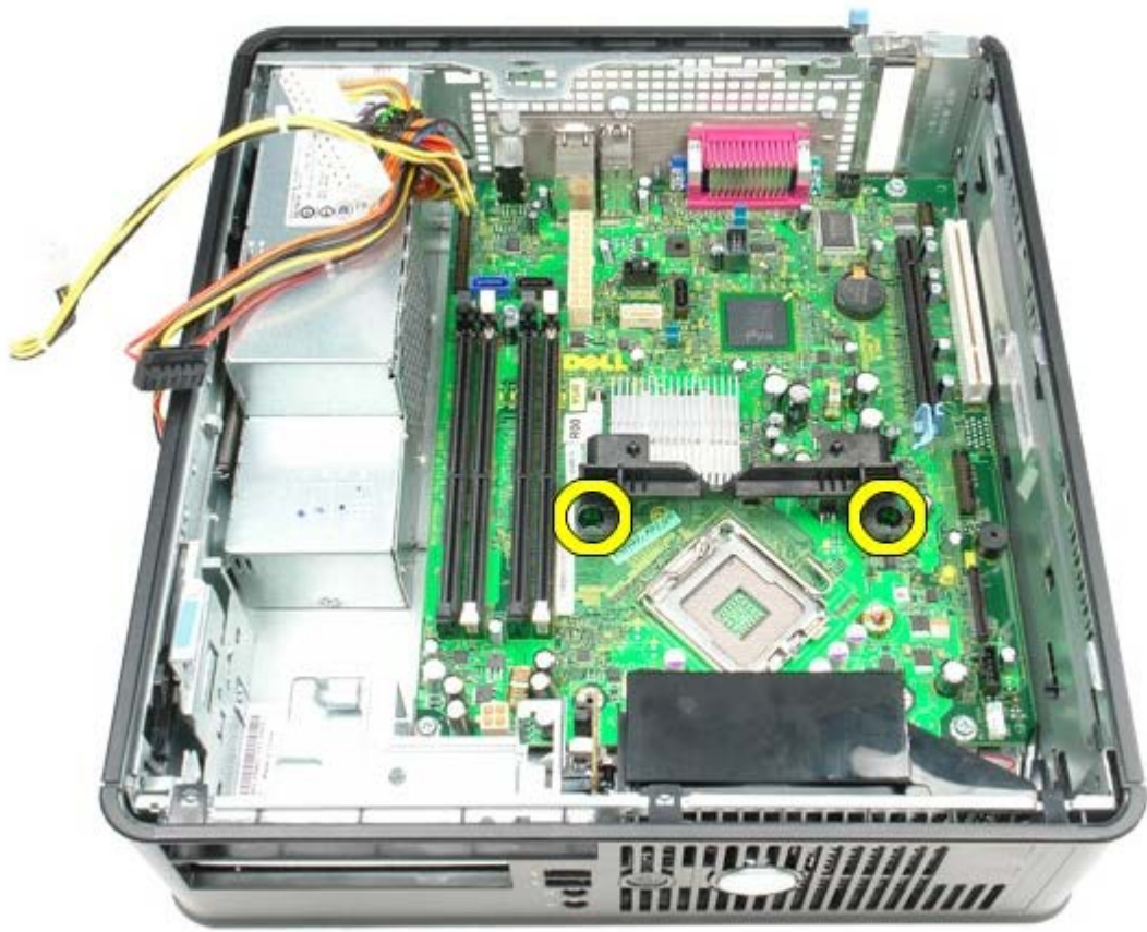
1 1 11 卸下散热器固定模块。
