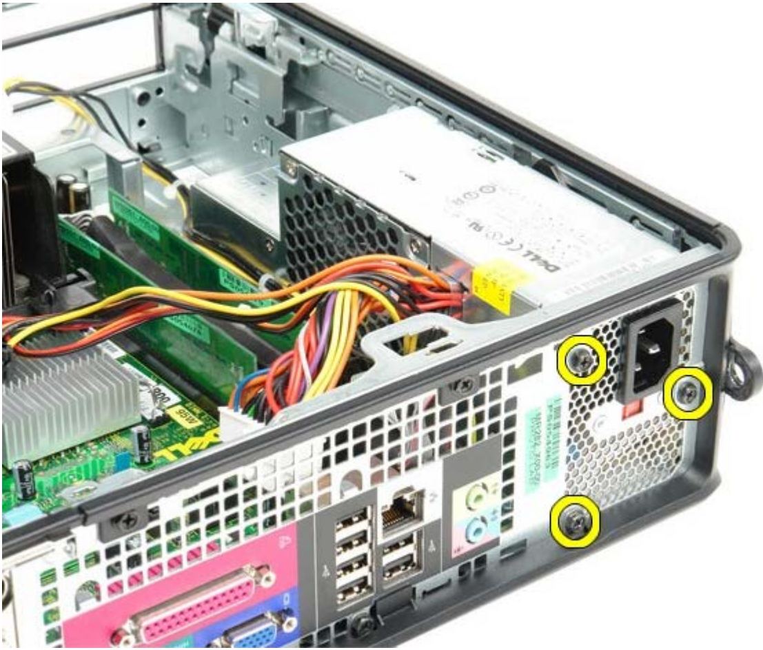
1 11 朝计算机的正面滑动电源设备。
