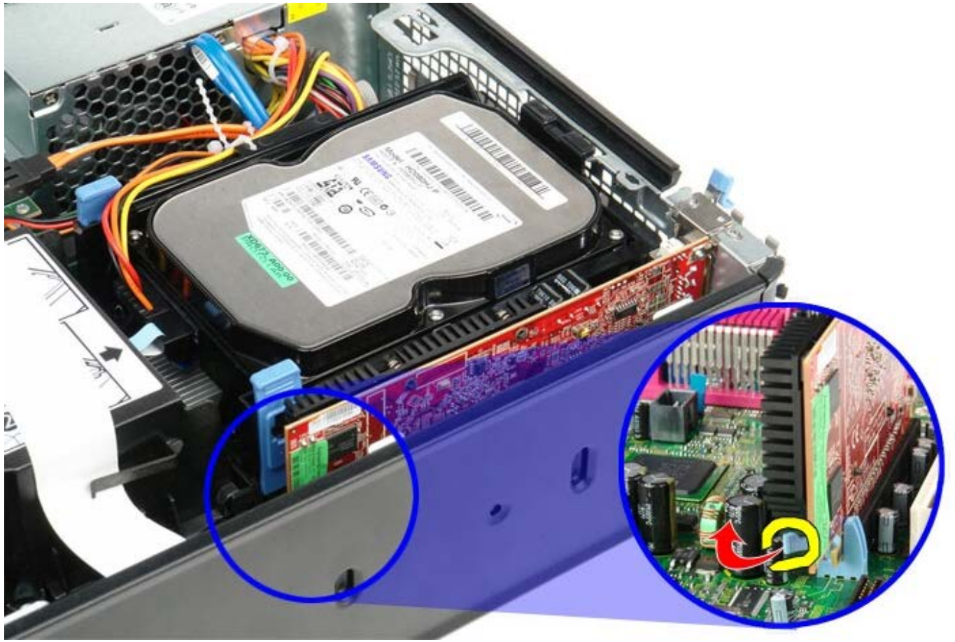
1 11 1 11 拿着插卡的顶部边角，轻轻地将其从连接器中取出。
