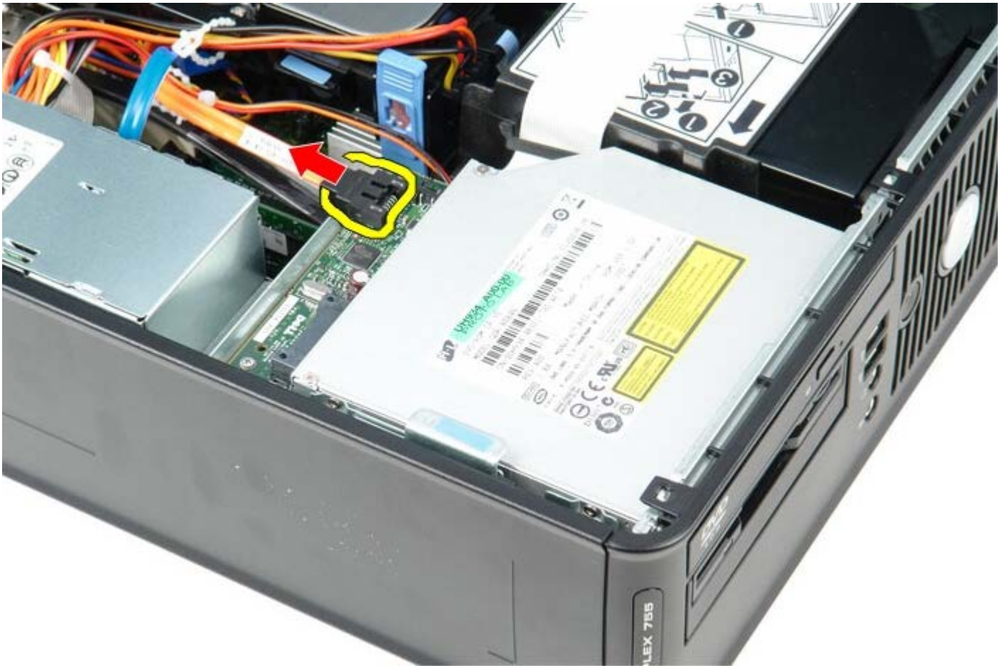
1 11 向上拉动驱动器释放闩锁，并朝计算机背面滑动光盘驱动器。
