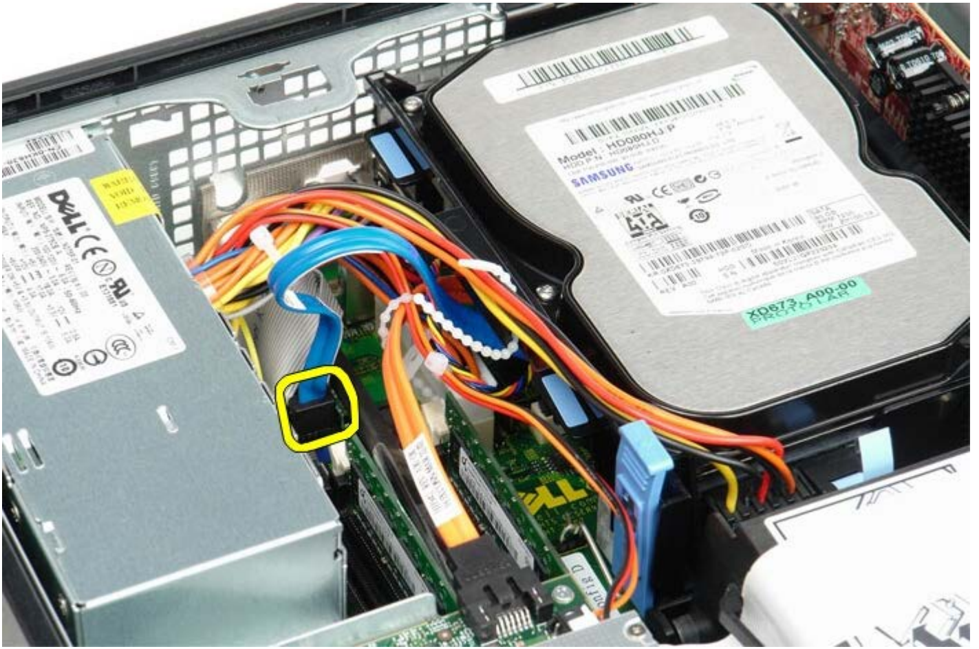
1 11 向内按压硬盘驱动器支架两侧的蓝色固定卡舌，然后向上滑动该驱动器支架使其脱离计算机。
