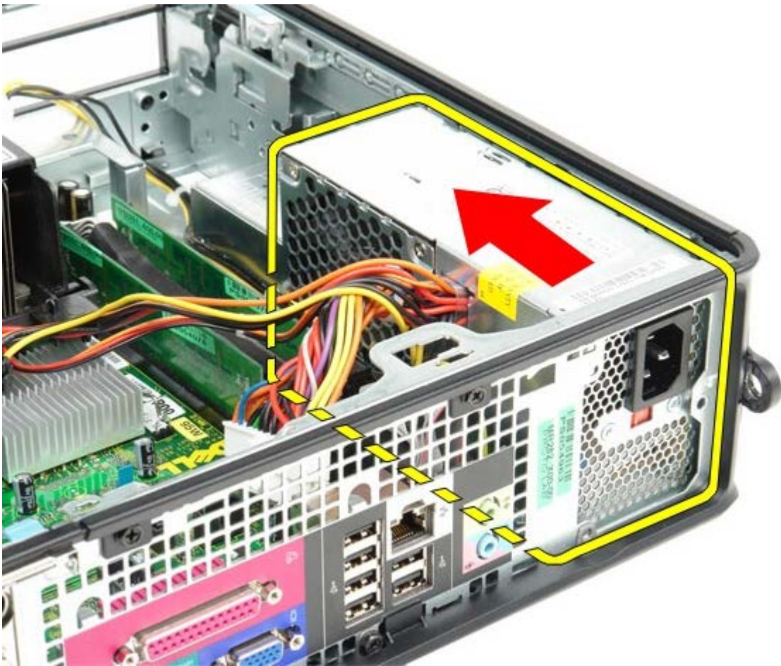
1 11 提起电源设备，将其从计算机中取出。
