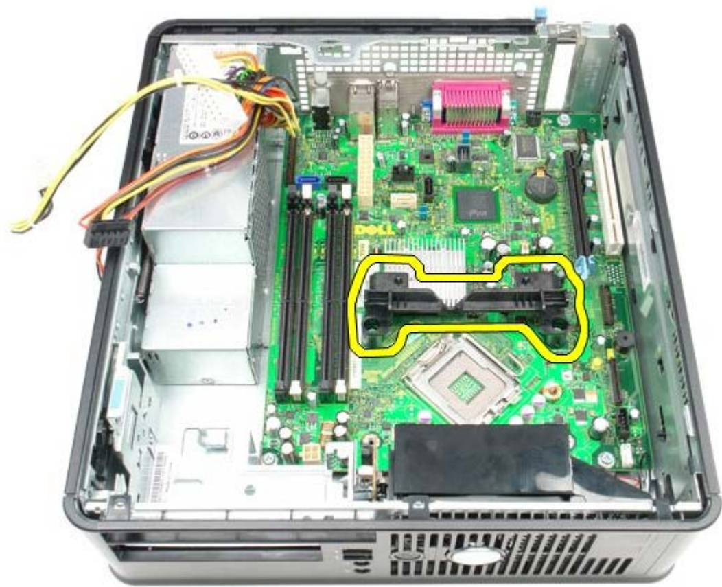
1 1 11 拧下将系统板固定到计算机机箱的螺钉。
